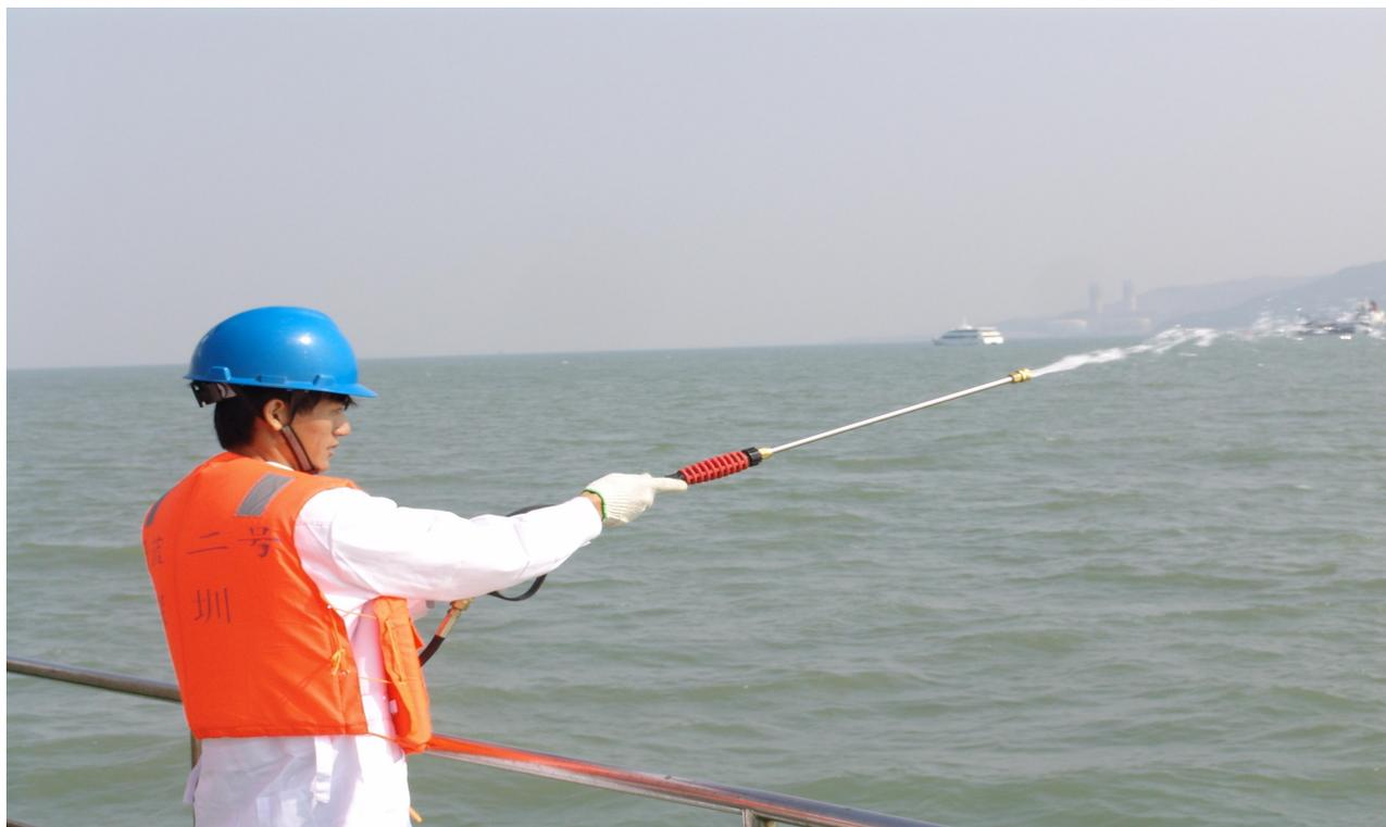
图 17 手持式溢油分散剂喷洒
