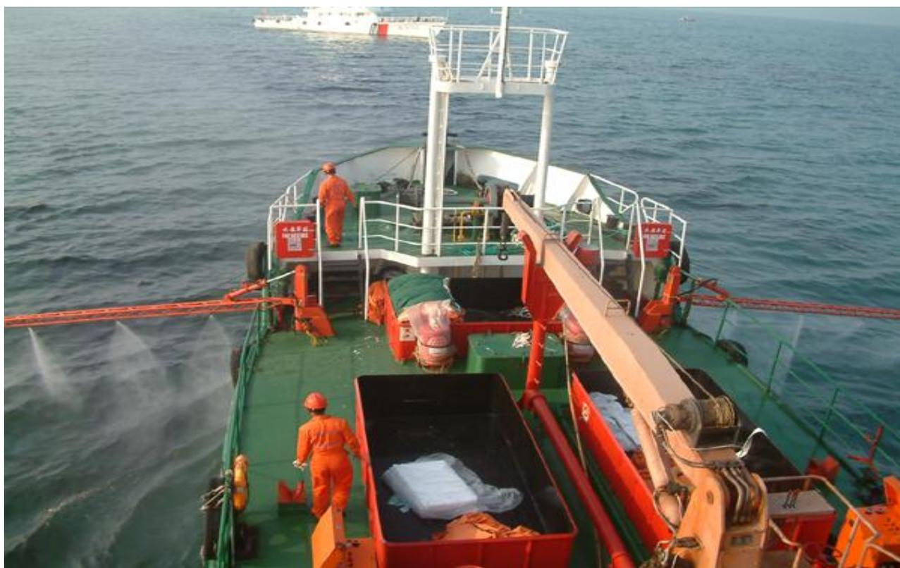
图 16 船载喷洒装置在喷洒溢油分散剂
