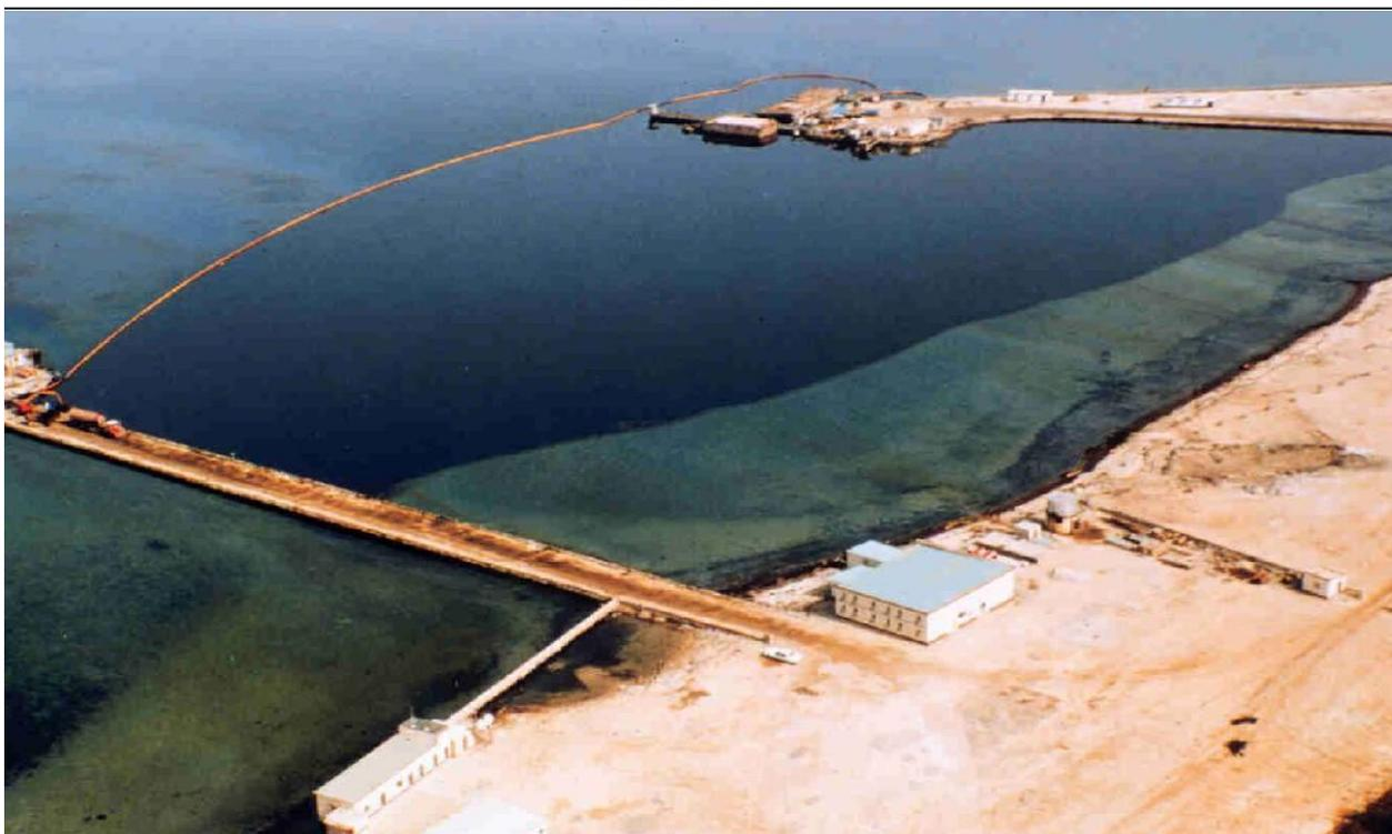
图 9 港口码头围油栏的布控
